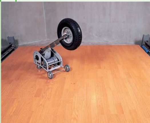
床衝撃音遮断性能試験
