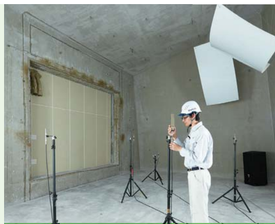
空気音遮断性能試験
