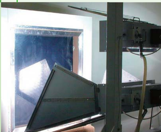
人工光源による日射熱取得率試験
