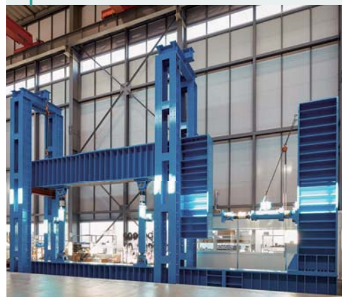
大型構造物複合加力試験装置
