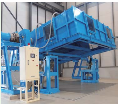
気密・水密・耐風圧試験（屋根・トップライト用）
