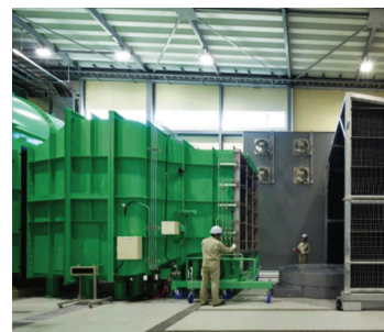
大型送風散水試験装置
