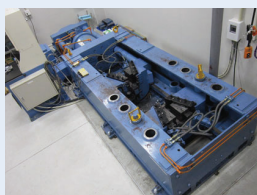
〈福岡試験室〉横型2000kN引張試験機を保有し つかみ間隔1100mmまでの試験に対応
