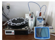
コンクリートコア 塩分電位差測定試験装置
