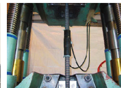
2000kN万能試験機による 各種継手引張試験
