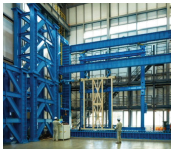
耐力壁の面内せん断試験
