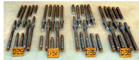
鉄筋継手試験片(引張試験後)
