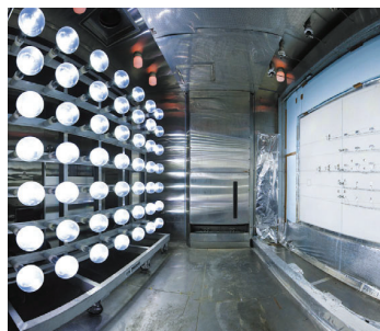
外装材の温冷繰返し耐久性試験
