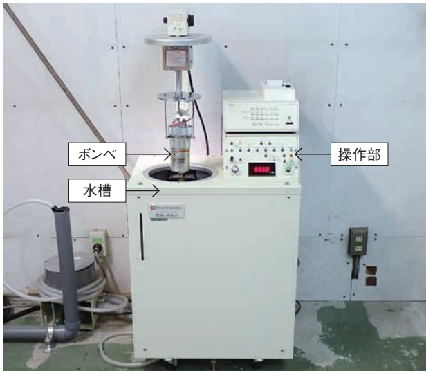
写真1 ボンプカロリメーターの外観
