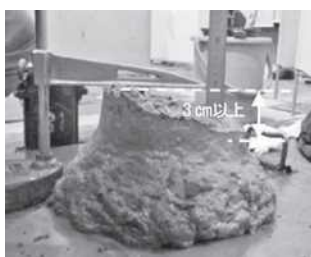
写真-7 スランプ上面の高低差 j)
