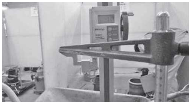
写真-5 ゼロ点のずれたスランプ測定尺
