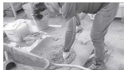
写真-11 フレッシュコンクリートのスランプフロー試験
