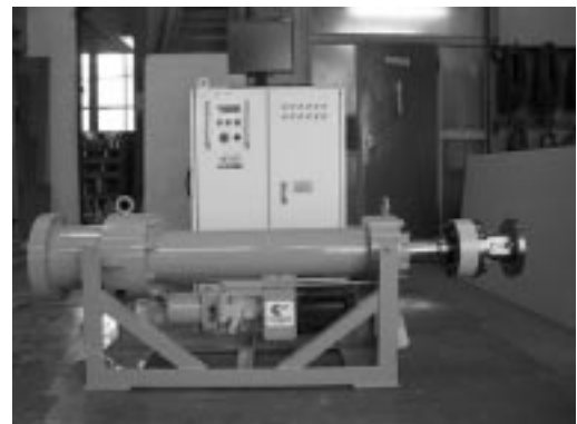
写真 アクチュエータ部及び制御操作盤
