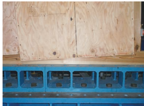
写真4 破壊状況 脚部近傍のパンチングアウト
