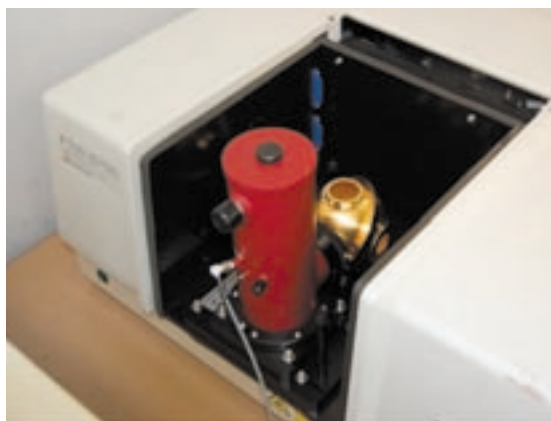
写真2 FTIRに積分球を取り付けた状態
