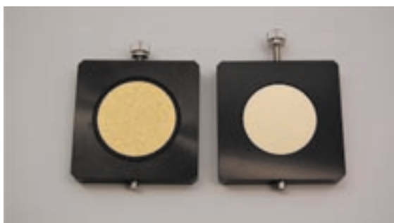
写真3 標準板（左が拡散面、右が鏡面）
