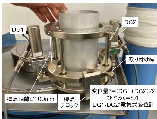
写真1 供試体取り付け前の測定装置
