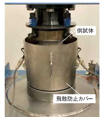
写真2 供試体取り付け後の測定装置
