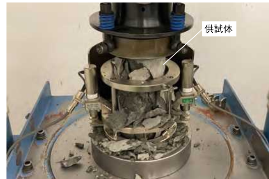
写真4 試験後の供試体の破壊状況
