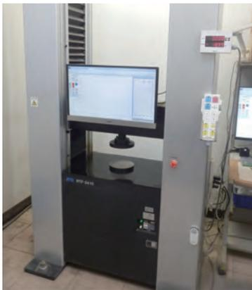
写真3 一軸圧縮試験機の外観
