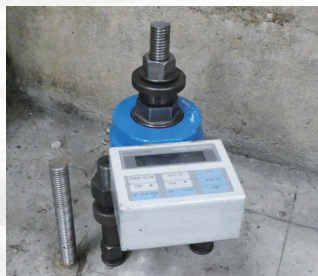
あと施工アンカーの引張試験
