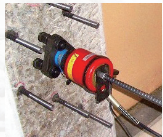
あと施工アンカーの引張試験
