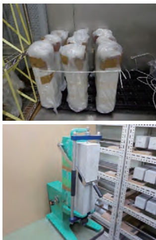
写真9 コンクリートの反応性試験状況 8) (上：40℃恒温室内での被覆養生、 下：長さ変化率の測定)
