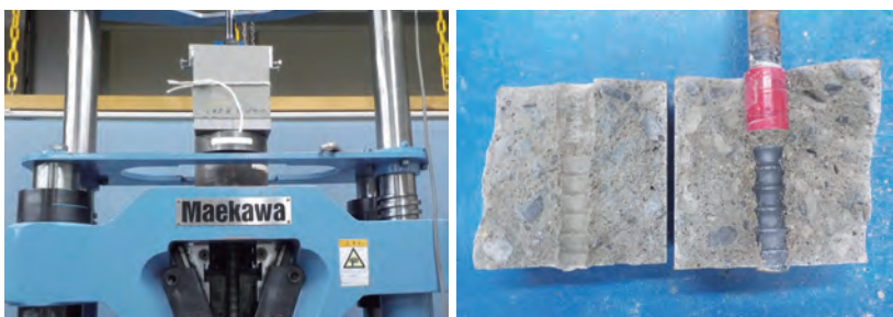
写真8 付着強度試験
