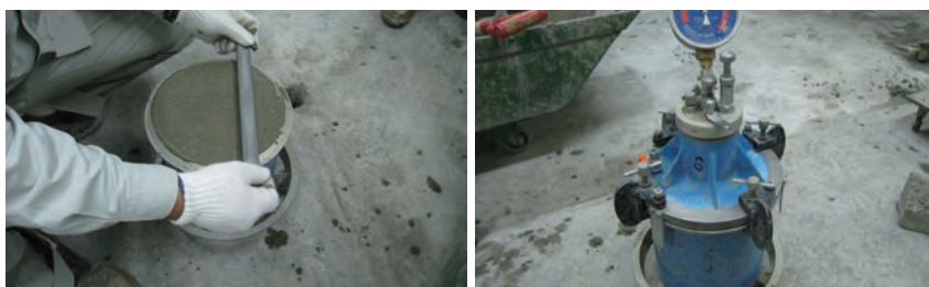
写真4 空気量試験状況 2)
