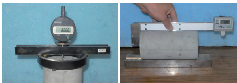
写真3 平面度および直角度測定 4)
