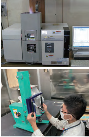
写真7 骨材のアルカリシリカ反応性試験 5) (上：化学法、下：モルタルバー法)
