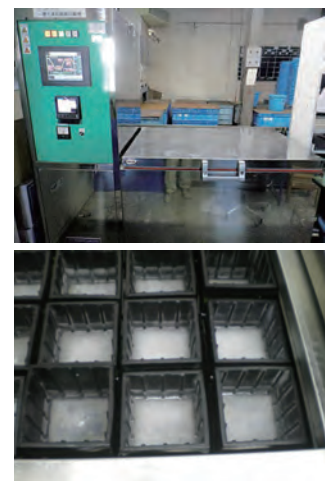
写真3 凍結融解試験状況 (上：促進試験装置外観、下：凍結状況)
