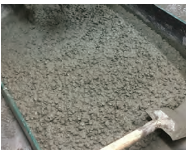
写真1 固まる前のコンクリート (練り混ぜ直後のフレッシュコンクリート)
