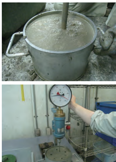
写真5 凝結時間試験状況 2)
