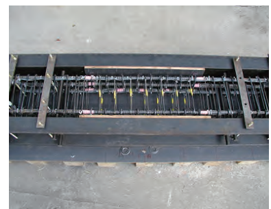
写真3 コンクリートを打ち込む前の 鉄筋骨組および型枠(試験体)
