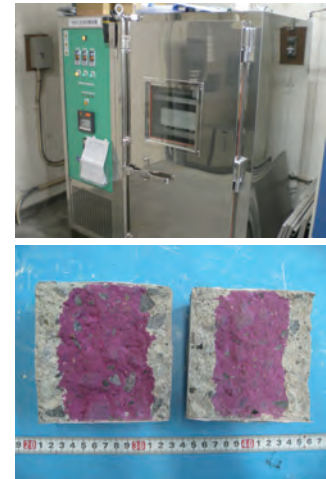
写真1 促進中性化試験状況 2) (上: 促進試験装置外観、下: 呈色反応)
