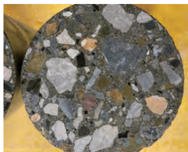
写真2 固まった後のコンクリート (硬化後のコンクリート断面)
