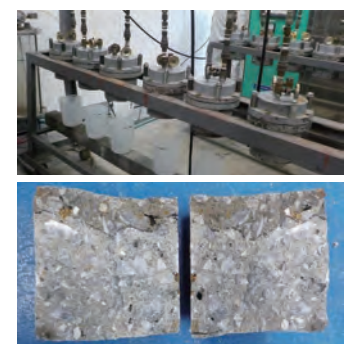
写真5 加圧透水性試験状況
