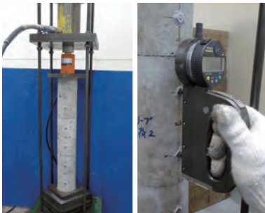
写真2 圧縮クリープ試験状況
