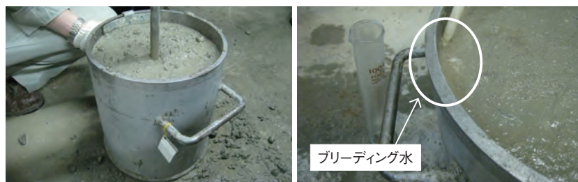
写真3 ブリーディング試験状況 2)
