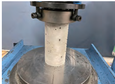
写真4 コンクリートの圧縮強度試験
