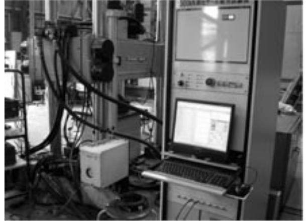
写真 500kN油圧サーボ疲労試験機と制御盤
