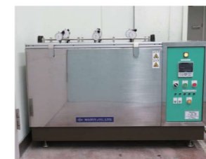
■道路用鉄鋼スラグの水浸膨張試験装置 道路用鉄鋼スラグの道路用資材としての適性を確認する試験に対応
