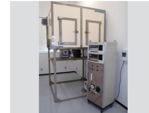
■表面試験装置 建築物の内装材料・工法の難燃性能を確認する試験に対応
