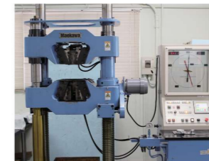
■引張試験機 鋼材の圧接継手・溶接継手・機械式継手の引張試験に対応
