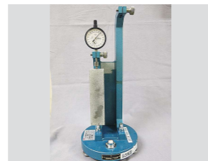
■長さ測定器 骨材のアルカリシリカ反応性を判定するモルタルバー法に対応
