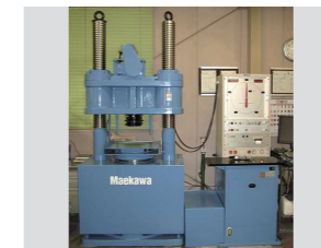
■圧縮試験機 コンクリート・モルタルの圧縮強度試験に対応
