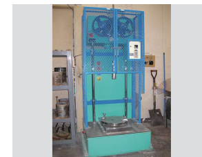
■土の突固め試験装置 路床・路盤材料・埋め戻し材料の最大乾燥密度・最適含水比・CBR試験を行うための突固めに使用
