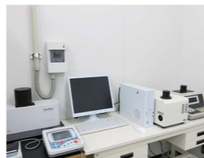
■光沢度計・測色計 (左:光沢度計 右:測色計) 塗膜・塗料・金属材料などの測色や光沢の測定に対応
