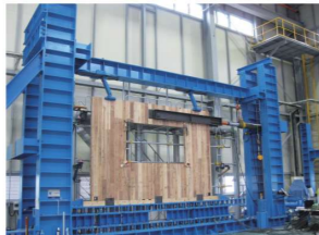
■大型面内せん断試験装置 壁・床・屋根など主要構造部位の面内せん断試験に対応
