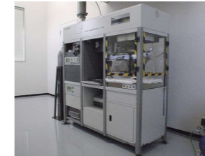
■発熱性試験装置 建築基準法で定められた防火材料(不燃材料・準不燃材料・難燃材料)やJIS・ISO規格に準ずる試験に対応
