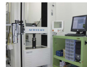
■100kNオートグラフ万能試験機 金属・プラスチックの引張・曲げ試験をはじめ、土の一軸圧縮強度試験やコンクリート試験に対応
