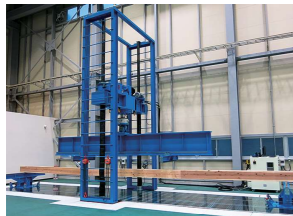
■1000kN構造物曲げ試験装置 梁部材・杭などの長支持スパン(10m)の曲げ試験に対応
