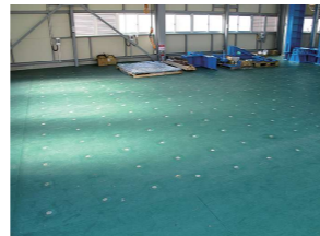
■構造反力床 ジグを設置することにより各種構造試験に対応
