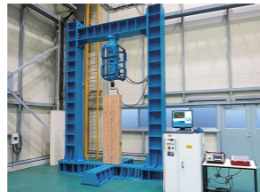
■200kN構造物試験装置 圧縮・引張・曲げ試験に対応
