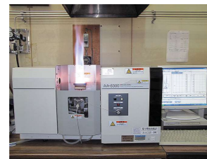
■原子吸光度計 骨材のアルカリシリカ反応性を判定する化学法に対応
