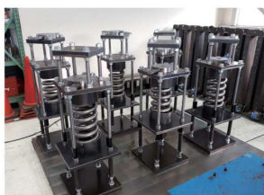
■あと施工アンカーのクリープ試験装置 あと施工アンカーの長期引張試験に対応
