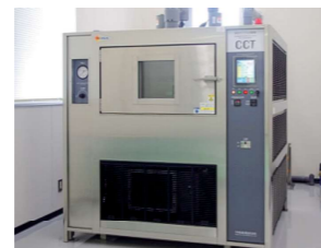
■複合サイクル試験機 塩水噴霧・乾燥・湿潤などの複合的な環境条件の設定や塩害状態を再現し、それらの各種条件を組み合わせさせたサイクル試験に対応
