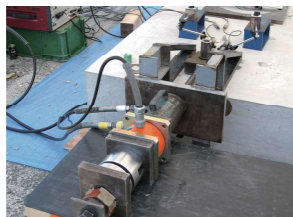
■アンカー試験装置 各種アンカーの強度試験に対応
