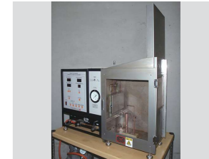
■45° 燃焼性試験装置 材料の難燃性能や防炎性能を確認する試験に対応
