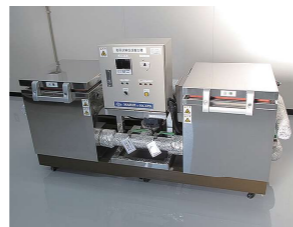
■膨張試験促進養生装置 (2槽切替式) 実構造物から採取し、促進養生させたコンクリートコアの膨張率によるアルカリシリカ反応性試験に対応
