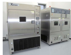
■促進耐候(光)性試験機 (キセノンウェザー) 左:低温サイクル 右:2槽独立型 太陽光・温度・湿度・降雨などを再現する耐候(光)性試験に対応
