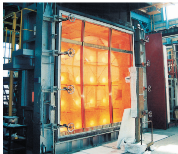
鋼製窓の遮炎性能試験
