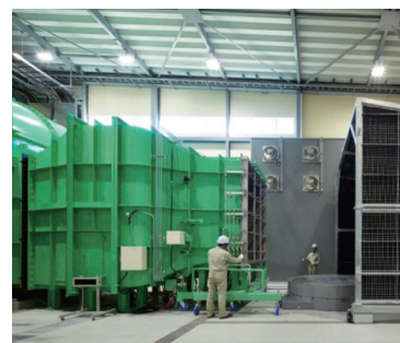
大型送風散水試験装置
