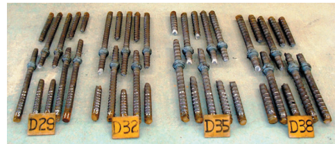
鉄筋継手試験片(引張試験後)
