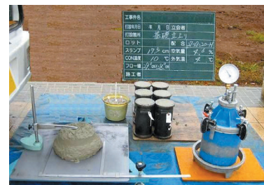
コンクリートの現場品質管理試験
