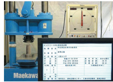
圧縮計測システムによる コンクリートの圧縮強度試験
