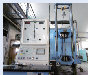
〈船橋試験室〉2000kN万能試験機を保有し 試験体長さ3mの引張試験に対応
