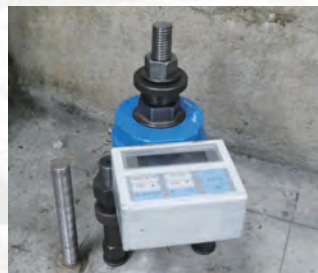
あと施工アンカーの引張試験
