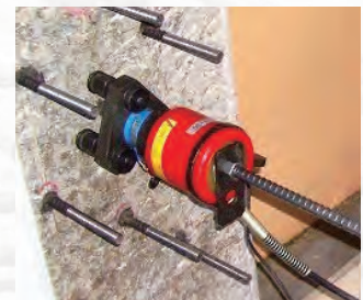
あと施工アンカーの引張試験
