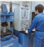
2000kN圧縮試験機 コンクリートの圧縮強度試験機として、自動制御かつ圧縮計測システムとの連携により、圧縮強度試験結果を自動的に取得。
