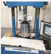
CBR貫入試験装置 自動突き固め装置、養生水槽(吸水膨張試験)、CBR貫入試験装置を保有しており、路盤材のCBR試験が可能。
