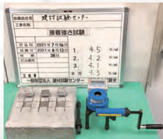
モルタルの付着強度試験
