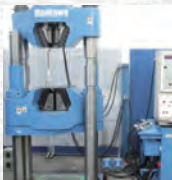
2000kN万能試験機 鉄筋・鋼材の引張試験機として、防振装置を備えた自動制御試験機。鉄筋はD51まで試験可能。
