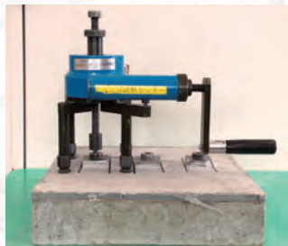
モルタルの付着強度試験
