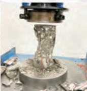
3000kN圧縮試験機 コンクリートの圧縮強度試験機として自動制御かつ圧縮計測システム導入により圧縮強度試験結果を自動的に取得。
