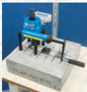
モルタル接着強度試験機 タイル・モルタル等の付着力を測定する試験機。最大荷重20kNまで試験可能。
