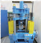
300kN曲げ試験機 鉄筋D10～D51の押し金具を保有し、各材質に対応可能。
