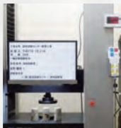
土の一軸圧縮試験機 JIS A 1216(土の一軸圧縮試験方法)及びJIS A 1108(コンクリートの圧縮強度試験方法)に対応しており、変位制御と荷重制御が可能。
