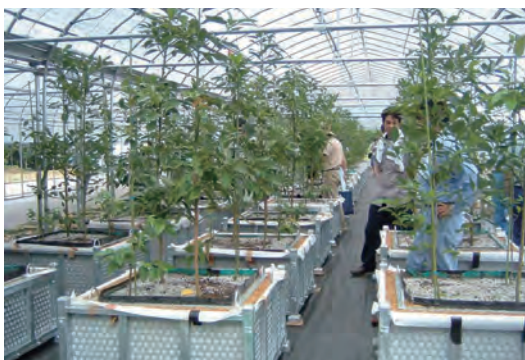
写真7 植物を用いた防水層の耐根性試験
