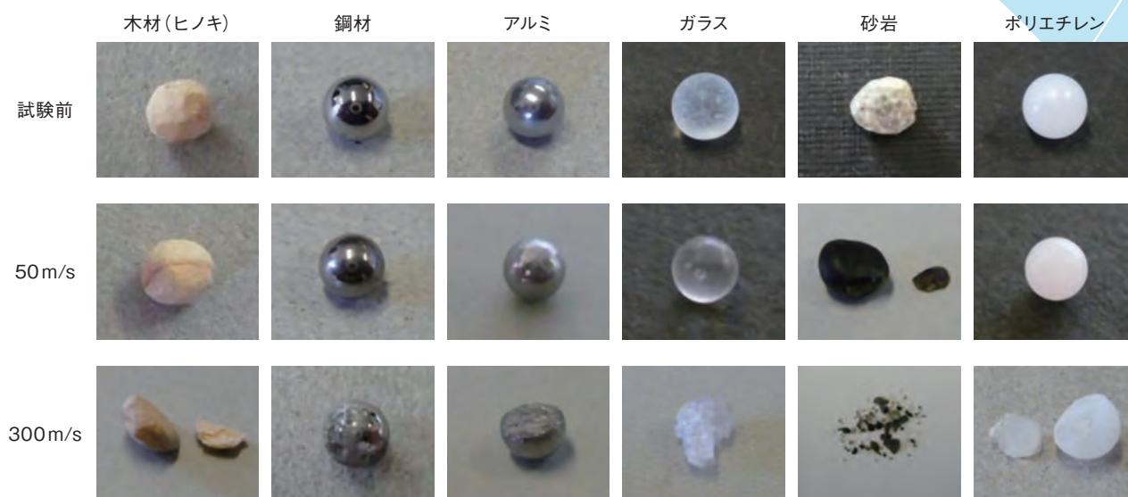
写真6 各種建築材料で作った球体がモルタル板衝突後の状況
