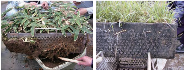
クマザサ ノシバ 写真3 地下茎はやわな防水層を突き破る
