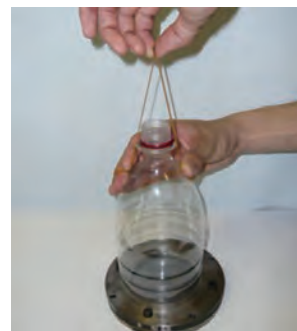
写真2 ゴムパチンコ式の低速衝撃試験
