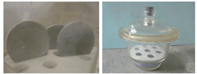
写真1 セメントペースト試験体と塩類の飽和水溶液で調湿したデシケータ
