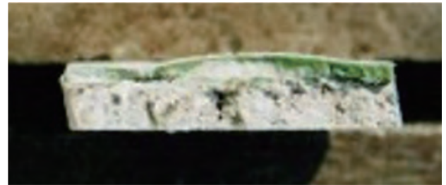
写真3 ふくれの断面 (内部の液水を液体窒素で凍結させ、切断して撮影)
