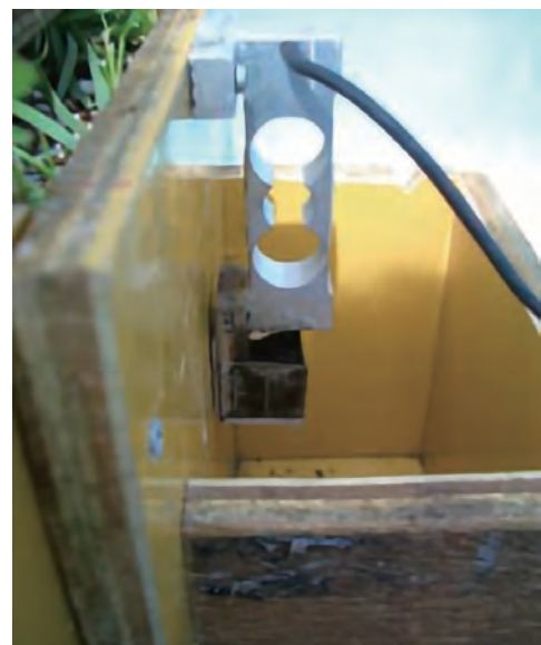
写真5 地下茎先端の押しつけ力測定装置
