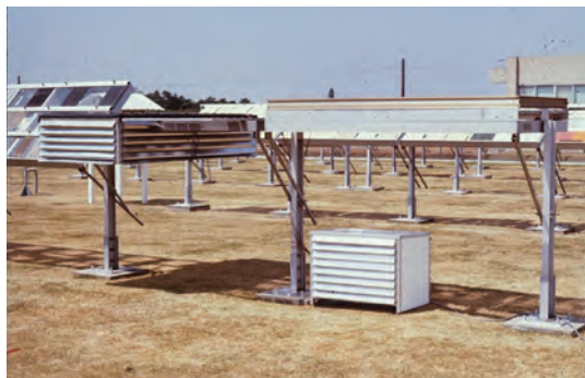
写真2 防水材料温度データを取りながらの屋外暴露試験状況 (右下の白い箱に記録計一式が入っている。)
