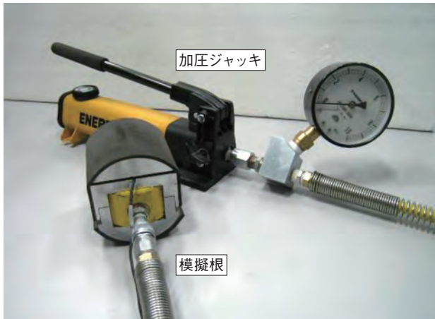
写真9 根の肥大による建築部材の損傷評価試験装置
