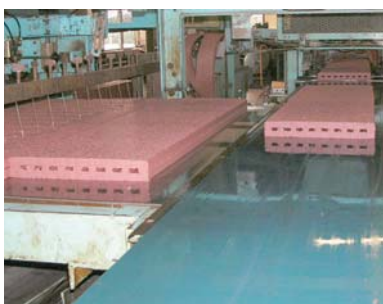
b) 押し成形とピアノ線切断
