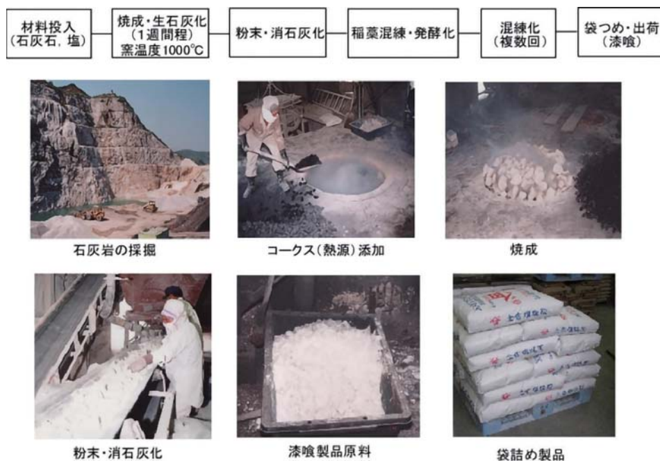
図1 伝統的な塩焼き灰の製造フロー
