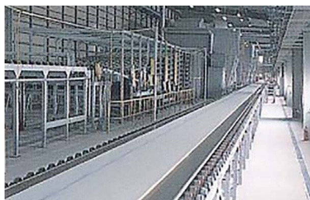
図3 石膏ボードの製造過程
