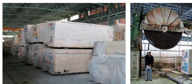
a) 輸入された大理石の原石(1.5×1.5×3.0m程度) b) ダイヤモンドソー切断機
