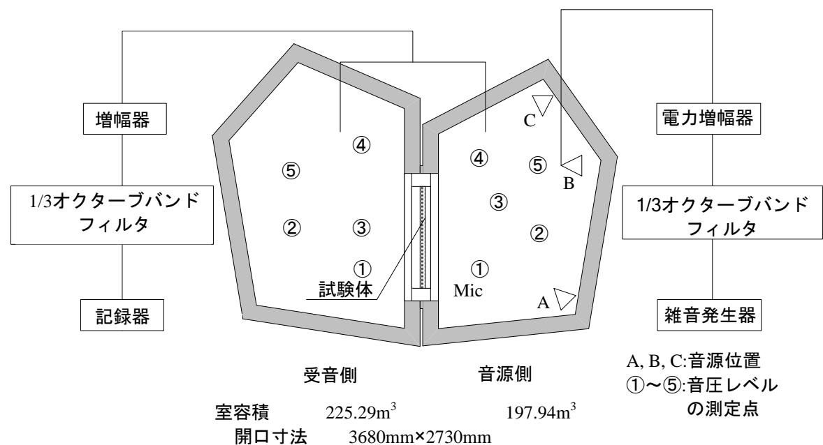
図\* 遮音性能試験装置の構成
