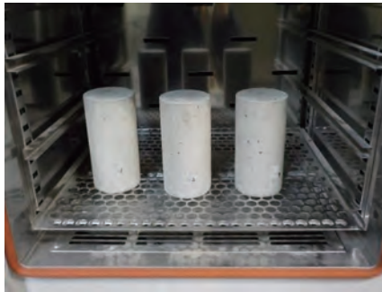
写真6 乾燥単位容積質量試験状況
