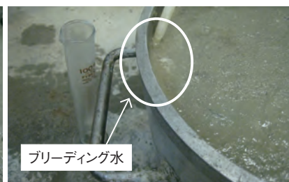
写真3 ブリーディング試験状況 2)
