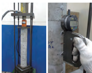
写真2 圧縮クリープ試験状況
