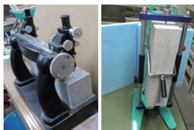
写真3 長さ変化率測定状況 (左: コンパレータ方法、 右: ダイヤルゲージ方法)
