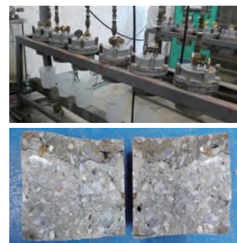
写真5 加圧透水性試験状況
