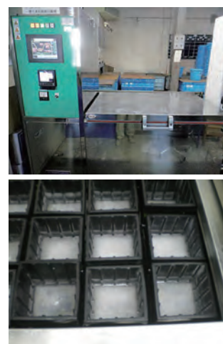
写真3 凍結融解試験状況 (上：促進試験装置外観、下：凍結状況)
