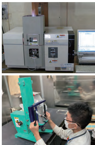
写真7 骨材の アルカリシリカ反応性試験 5) (上：化学法、下：モルタルバー法)
