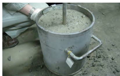
写真3 ブリーディング試験状況 2)
