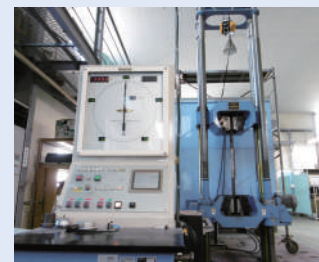
〈船橋試験室〉2000kN万能試験機を保有し 試験体長さ3mの引張試験に対応
