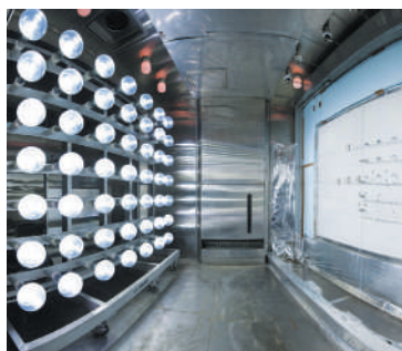
外装材の水冷繰返し耐久性試験
