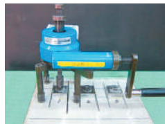
モルタル接着強さ試験
