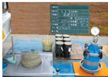
コンクリートの現場品質管理試験
