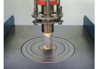
小径コアの圧縮強度試験
