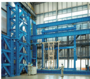
耐力壁の面内せん断試験
