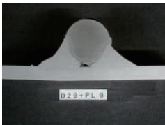
溶接継手断面マクロ試験
