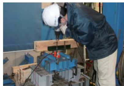
木造軸組工法に使用される座金のめり込み試験 (座金の短期許容めり込み耐力の認定)
