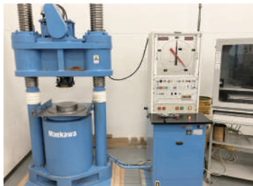
超高強度対応3000kN圧縮試験機 (武蔵府中試験室・福岡試験室)
