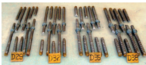
鉄筋継手試験片 (引張試験後)
