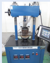
〈浦和試験室〉土木材料の試験に 幅広く対応 (CBR試験状況)
