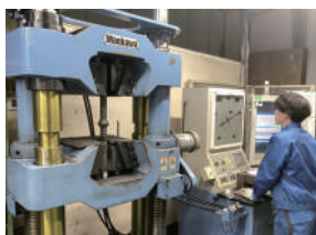
ガス圧接継手の引張試験
