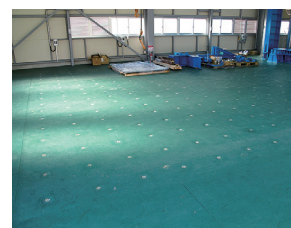
■ 構造反力床 ジグを設置することにより各種構造試験に対応
