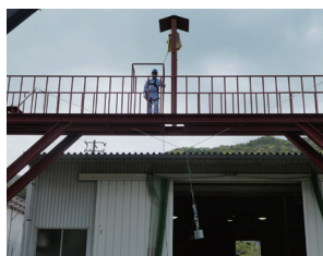
■現場での仮設機材の試験 親綱支柱の試験に対応
