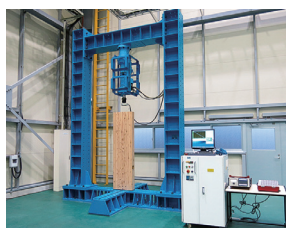
■ 200kN構造物試験装置 圧縮・引張・曲げ試験に対応
