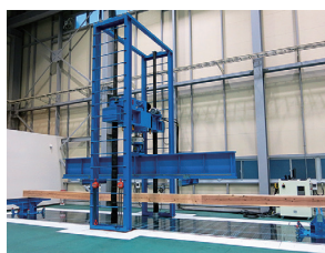
■ 1000kN構造物曲げ試験装置 梁部材・杭などの長支持スパン（10m）の曲げ試験に対応
