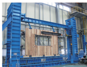
■ 大型面内せん断試験装置 壁・床・屋根など主要構造部位の面内せん断試験に対応
