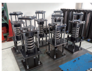
■ あと施工アンカーのクリープ試験装置 あと施工アンカーの長期引張試験に対応
