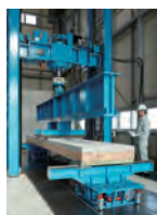
[今号の表紙] 木材とコンクリートの ハイブリッド床の曲げ試験
