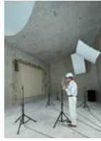
[今号の表紙] 遮音性能試験で使用する 残響室の内観 (マイクロホンの校正の様子)
