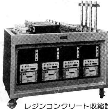
レジンコンクリート収縮試験機
