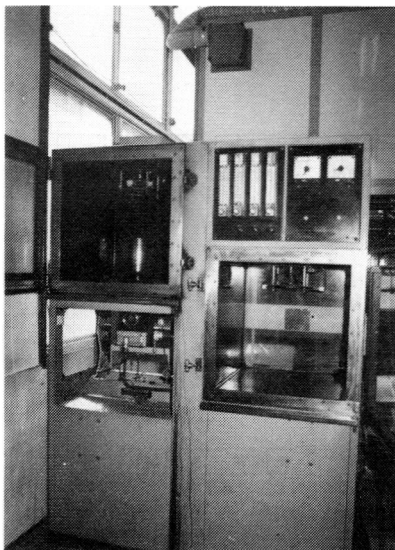
写真-4 ガス有害性試験装置(本体及び加熱炉)
