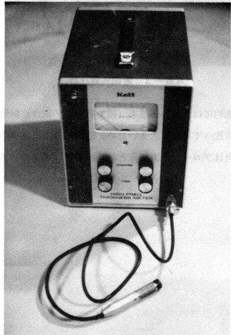
写真-2 うず電流式膜厚計
