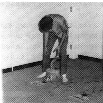
写真-1 砂袋による試験方法
