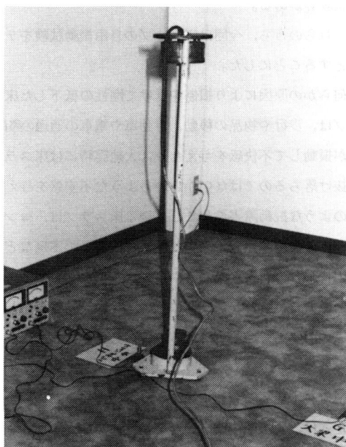
写真-2 重錘による試験方法
