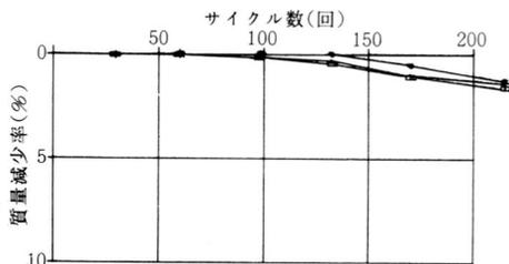
図-7 凍結融解試験結果
