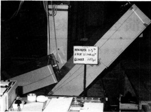
写真-2 スリーブ試験による鋼製家具の転倒状況
