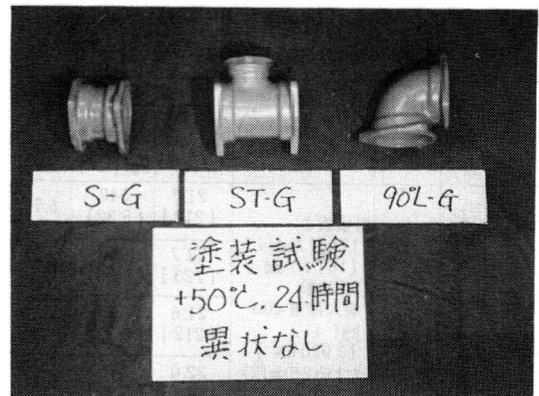
写真-14 試験体記号90° L-G、ST-G、S-Gの耐熱性試験終了後の状況
