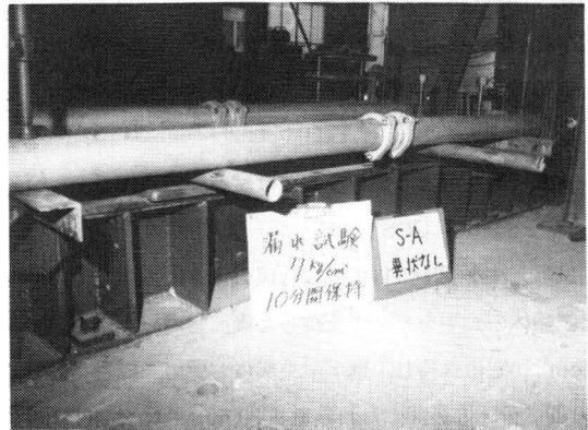
写真-1 試験体記号S-Aの試験終了後の状況
