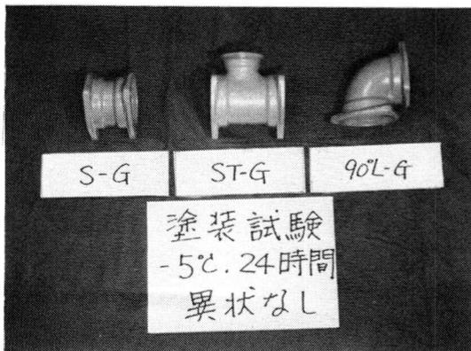
写真-13 試験体記号90° L-G、ST-G、S-Gの耐寒性試験終了後の状況
