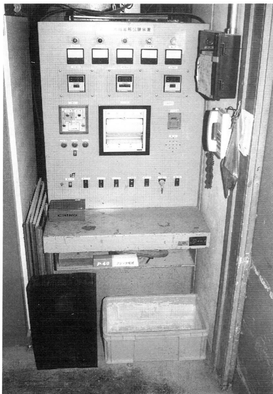
写真1 凍結融解試験装置（制御盤）
