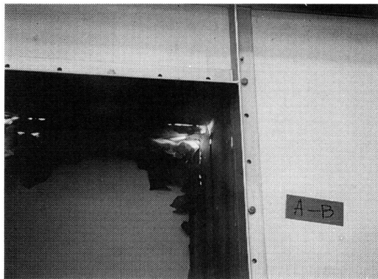
写真9 加熱開始後7分時のA、Bの発炎の状況 (コーナの燃焼は一部気密測定時に用いたシリコンシールが燃焼した。手前の接合部はA、奥はB接合部)
