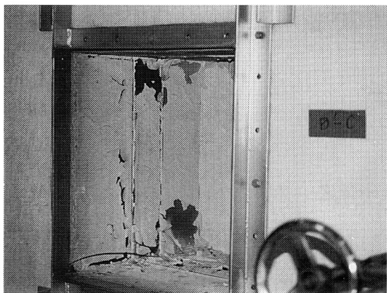
写真17 加熱開始後60分時のB'、Cの状況 (手前B'、奥C、加熱側)
