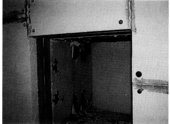
写真27 加熱後のD, Eの加熱側の状況
