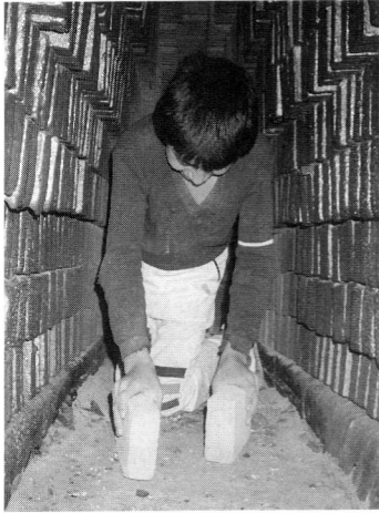
写真2 窯の内部で重油を燃し終えたところ (子供も重要な労働力)
