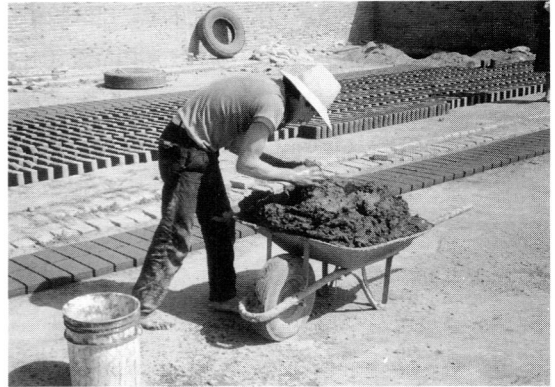
写真4 れんが製造工程② ストックされていた粘土を ネコで運搬してきて、こねている状況
