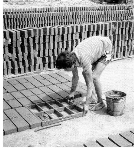
写真10 れんが製造工程① 木製型枠の設置
