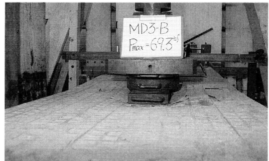
写真7 試験体記号MD 3-Bの破壊状況
