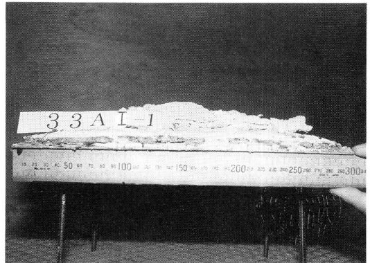
写真2 供試体記号 33A1 の板の反り(変形)の状況 (板厚さ 2.3mm)
