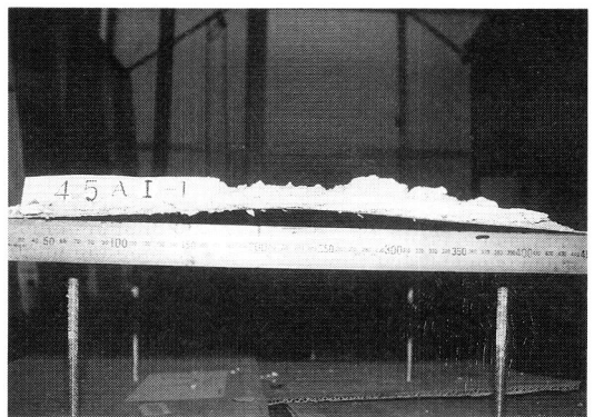
写真3 供試体記号 45A1 の板の反り(変形)の状況 (板厚さ 1.2mm)
