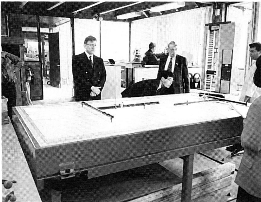
写真3 合板の等分布荷重試験状況 (鋼製ボックスの上に試験体を置きボックス内を真空状態にする)
