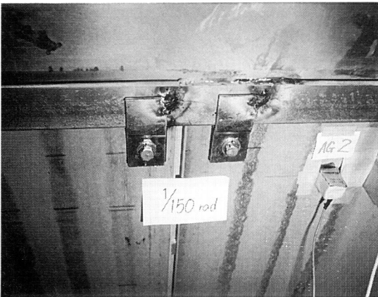
写真2 R_0 = 1/150 \text{ rad} の加振終了後の状況 (ボルトの回転)
