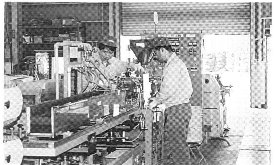
写真4 樹脂押出実験ライン
