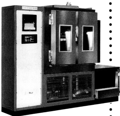
建築用外壁材料用 多目的凍結融解試験装置
