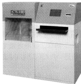
コンクリート全自動圧縮試験機 HI-ACTIS-2000, 1000kN
