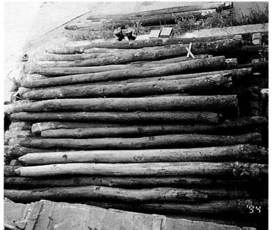
写真9 引き抜かれた杭群
