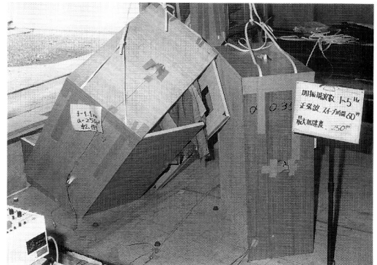
写真3 スイープ試験における木質系家具の転倒状況
