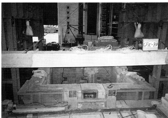
写真2 加熱終了後のCFK-8φの状況 (実大断面の1/2スケール断面)
