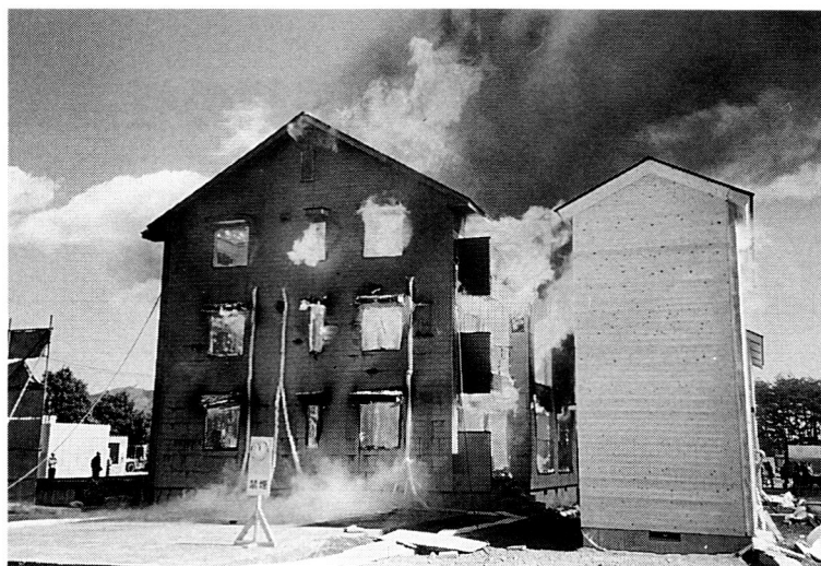
写真2 木三共建物の火災最盛期 (右側の建物は「延焼評価用建物」(在来軸組)の妻壁)
