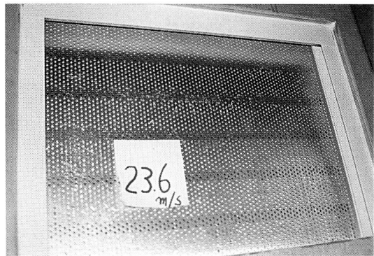
写真6 漏水状況 平均圧力：35kgf/m 2 (相当風速23.6m/s) 漏水状況：著しい流れ出し
