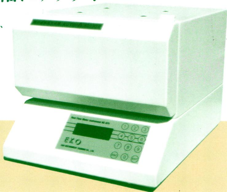
測定方式：熱流計法
