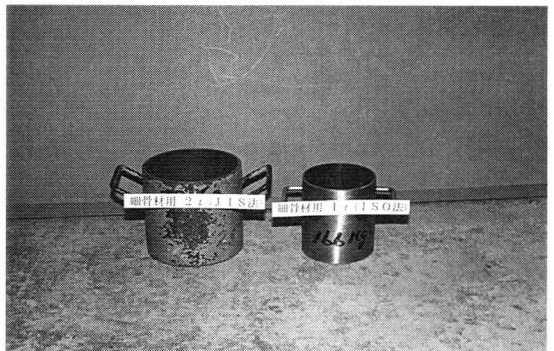
写真9 単位容積質量測定容器（細骨材の試験に使用するJISとISOの容器）
