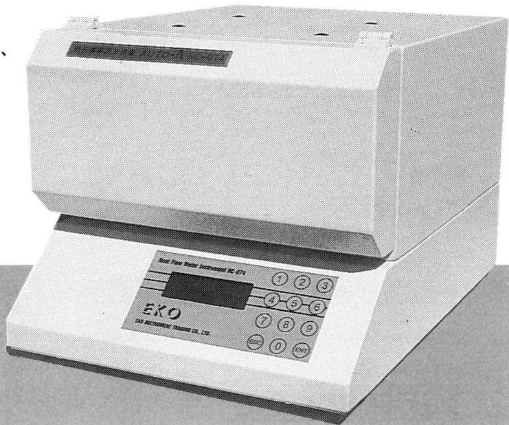
測定方式：熱流計法
