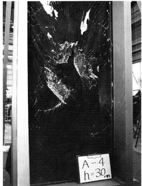
写真1 衝撃による破壊状況
