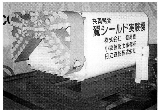
写真4 翼シールド工法の実験機(幅120cm、高さ80cm)
