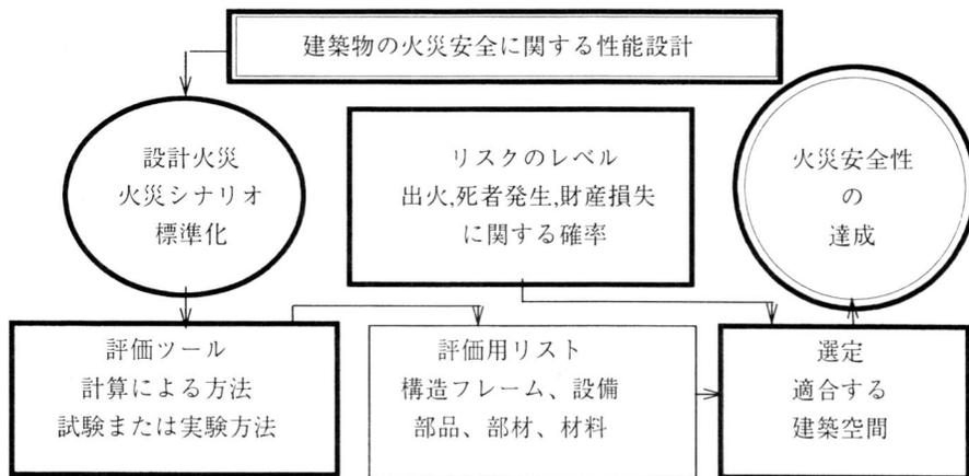
図1 建築物の火災安全性に関する性能設計の流れ
