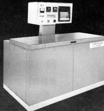
**凍結融解試験装置 (水中・水中専用機)**
