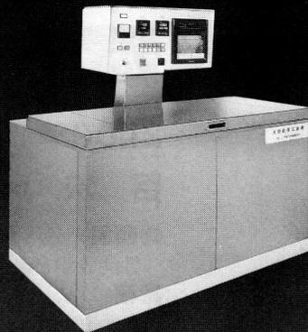
**凍結融解試験装置 (水中・水中専用機)**
